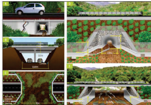
Ejemplos de estructuras que funcionan como pasos de fauna: A) caja de losa, B) paso superior de fauna, C) viaducto, D) paso inferior de fauna, E) puente. "
