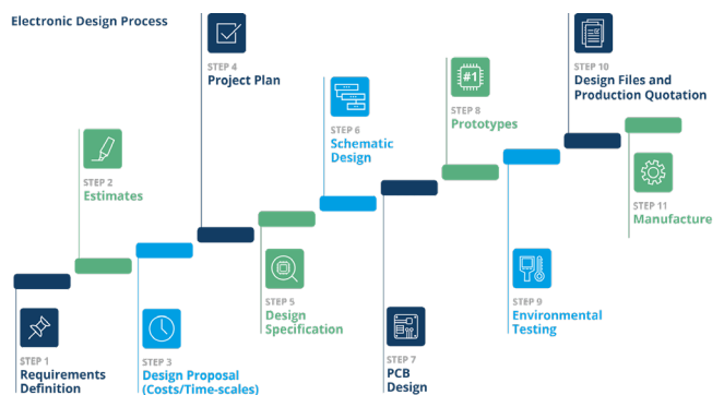
Figura 2. Proceso de diseño y fabricación de una solución electrónica.
