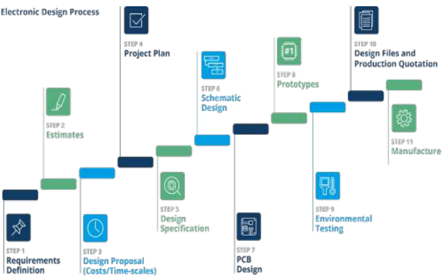
Figura 2. Proceso de diseño y fabricación de una solución electrónica.
