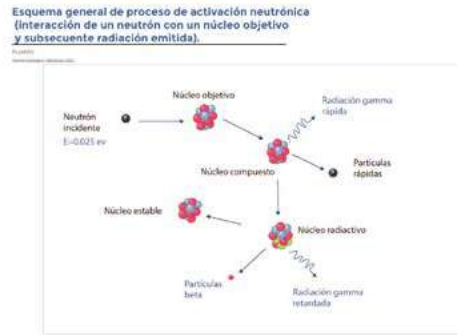
Figura 8. Esquema general de proceso de activación neutrónica (interacción de un neutrón con un núcleo objetivo y subsecuente radiación emitida).
